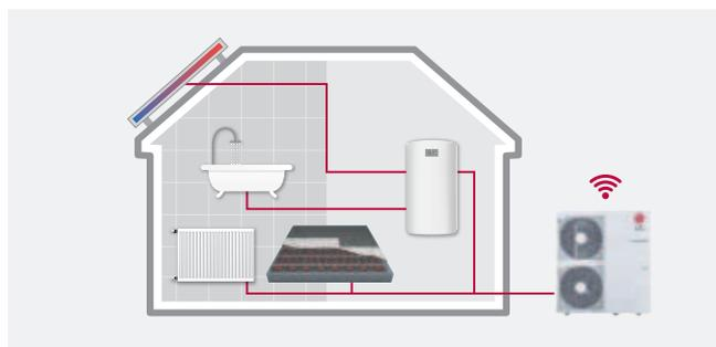
Die Warmwassertemperaturen von 58 - 80 °C sind nur in Verbindung mit zusätzlichem Heizstab erreichbar.
